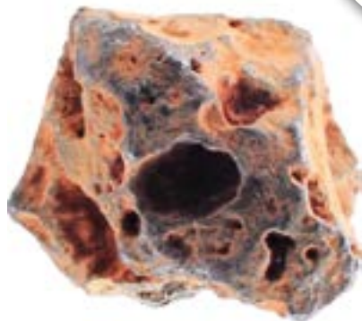
Bergung des Brennstoffs aus Fukushima: Hochradioaktive Krümel aus dem AKW, stark vergrößert
