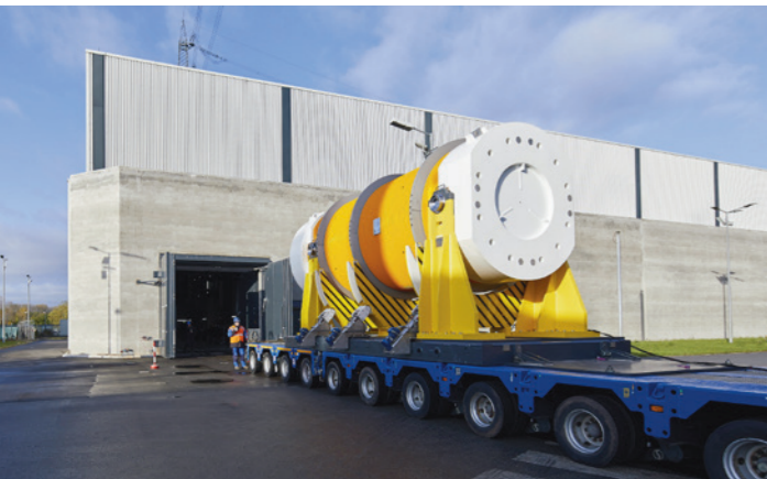
Transporter mit Castor-Behälter vor dem Zwischenlager Biblis
