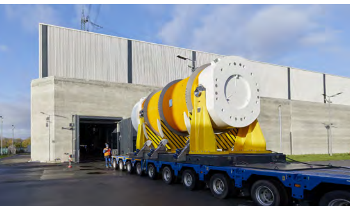
Transporter mit Castorbehälter vor dem Zwischenlager Biblis
