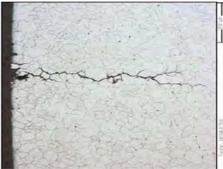
Figure 1: Kernkraftwerk Biblis A: Interkristalliner Rissverlauf in Wanddickenrichtung eines Dampferzeuger-Heizrohres (Gesellschaft für Anlagen- und Reaktorsicherheit (GRS) mit beschränkter Haftung 2009, S. 69)
