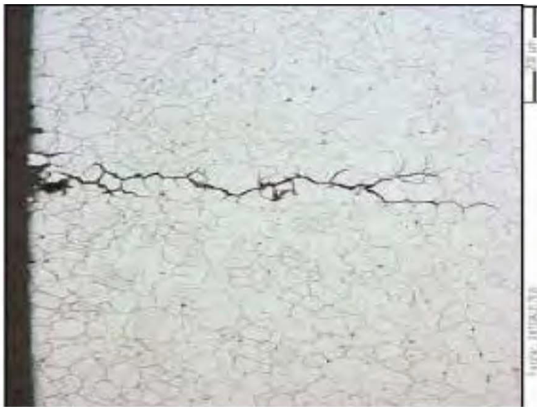
Figure 1: Kernkraftwerk Biblis A: Interkristalliner Rissverlauf in Wanddickenrichtung eines Dampferzeuger-Heizrohrs (Gesellschaft für Anlagen- und Reaktorsicherheit (GRS) mit beschränkter Haftung 2009, S. 69)
