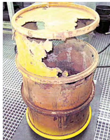
Durchgerostetes Fass aus dem AKW Brunsbüttel, 2012
