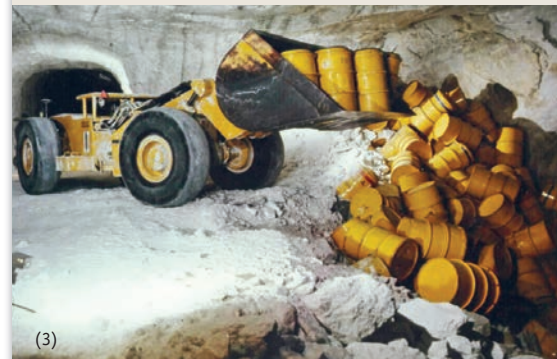
Das „Abkipfverfahren“ in der Asse galt damals als innovativ weil besonders kostengünstig
