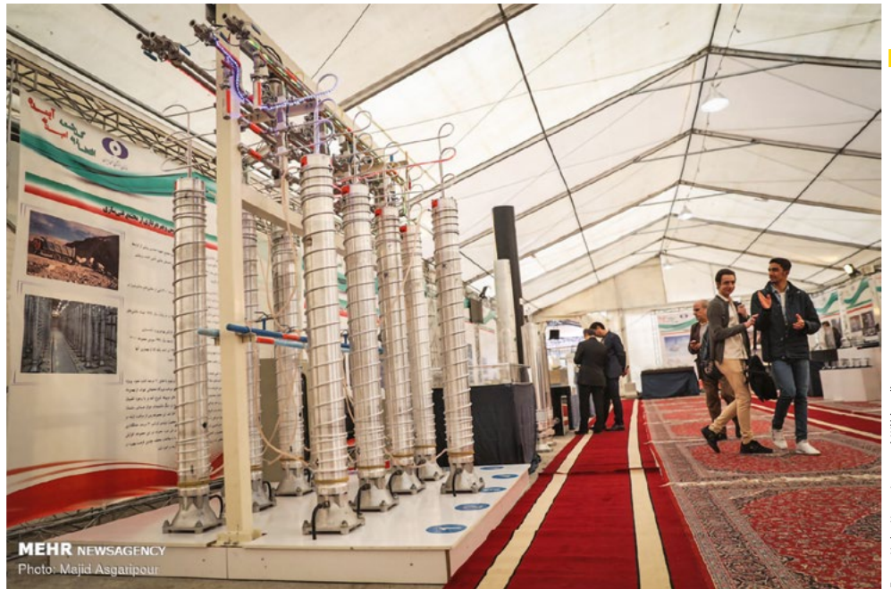
Gas-Zentrifugen zur Urananreicherung, ausgestellt auf der Eqtedar 40 defence exhibition in Teheran 2019
