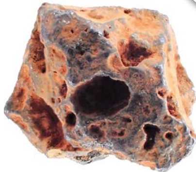
Bergung des Brennstoffs aus Fukushima: Hochradioaktive Krümel aus dem AKW, stark vergrößert
