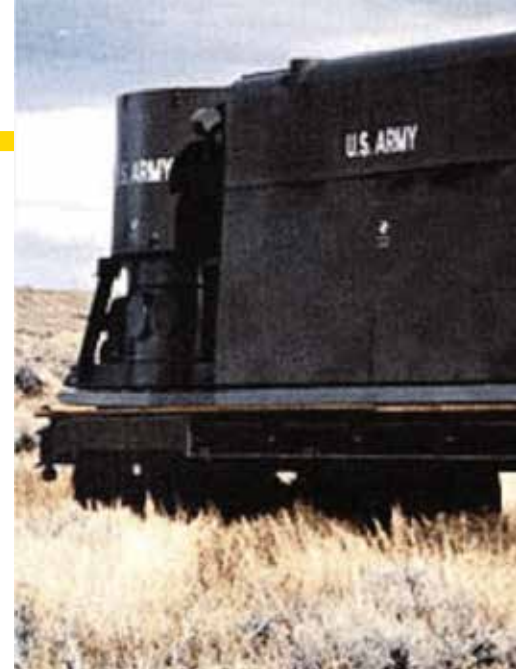
Prototyp ML-1 (hier: originalgroße Attrappe) eines mobilen Mini-AKW
